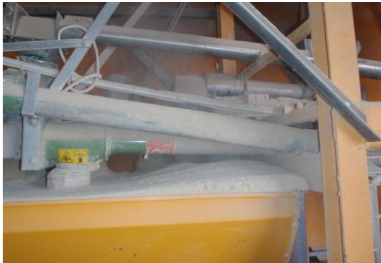
Abbildung 11: Staubablagerungen auf einem Futtermittelsilo in einer Futtermittelaufbereitungsanlage
