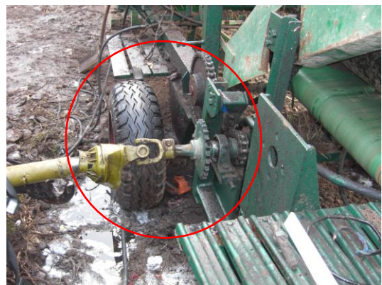
Abbildung 13: Unfallstelle am Transportband mit ungeschützten rotierenden Maschinenteilen Quelle: LAGuS M-V
