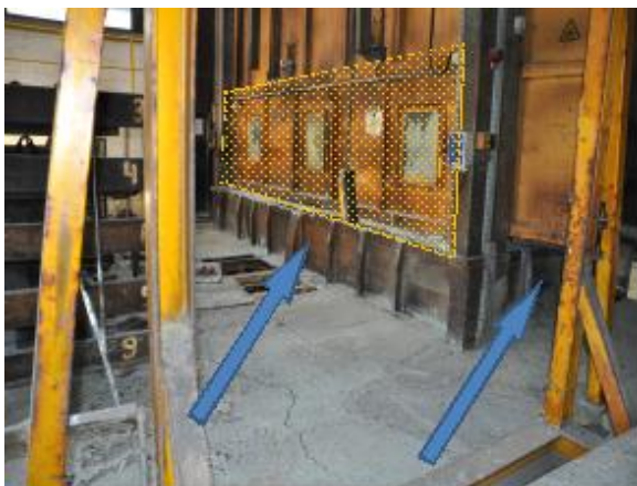
Abbildung 14: oberer Teil des Zinkbades (blaue Pfeile) mit Einhausung, orange markiertes Seitenteil kann hochgefahren werden, Quelle: LAGuS M-V
