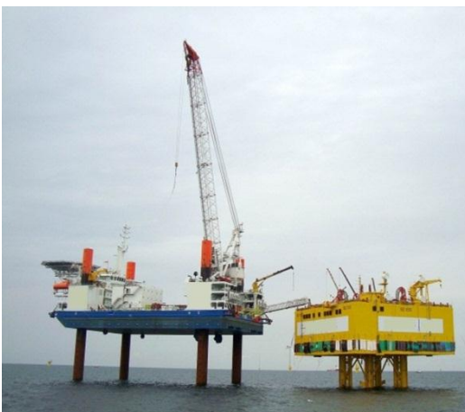
Abbildung 9: Hubinsel und Umspannstation Quelle Abbildungen 9 und 10: LAGuS M-V
