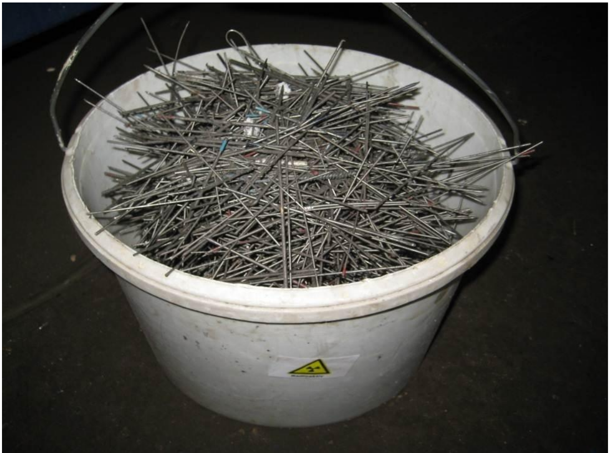
Abbildung 24: Detektierte thoriumoxidhaltige Elektrodenreste, Quelle: LAGuS M-V
