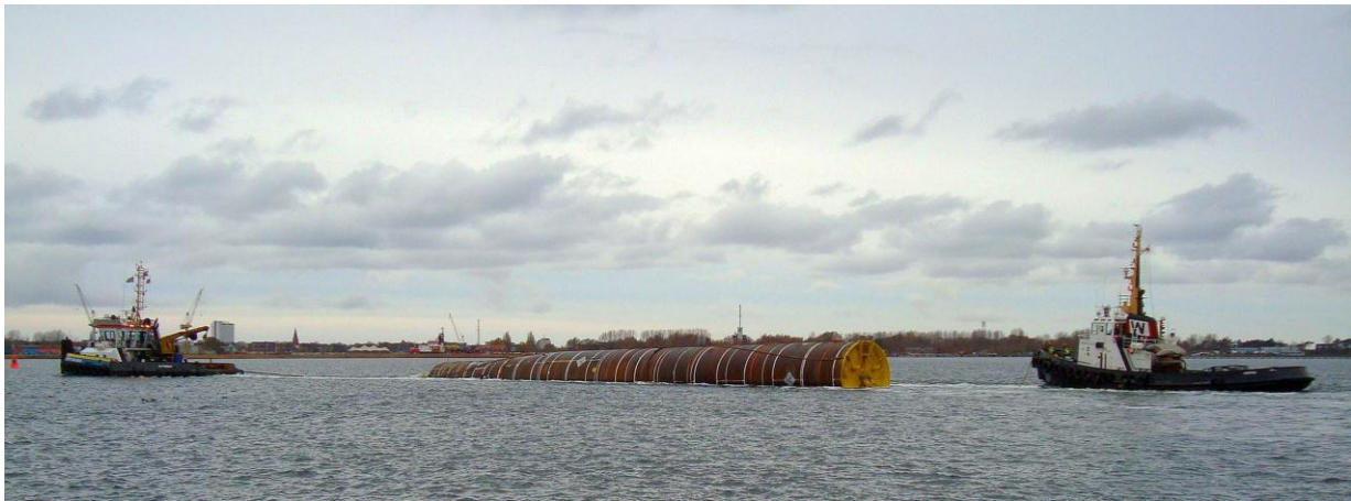
Abbildung 6: Schlepper mit Gründungsstruktur, Quelle: LAGuS M-V
