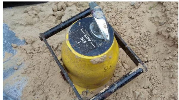
Abbildung 22: Abschirmbehälter mit manuellem Öffnungsmechanismus
