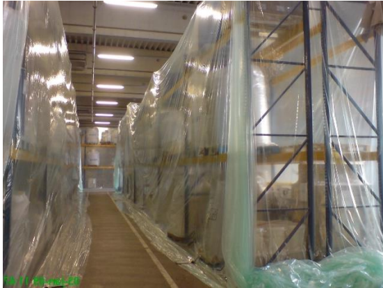
Abbildung 15: Begasung eines Hochregallagers mit Phosphorwasserstoff (PH 3 ) Quelle Abbildungen 15+ 16: VSH Vorratsschutz und Hygiene GmbH
