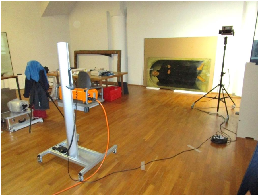
Abbildung 27: Prüfaufbau mit mobiler Röntgeneinrichtung, Quelle LAGuS
