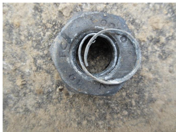
Abbildung 19: Mutter mit abgestreiften Gewindegang einer Schraube
