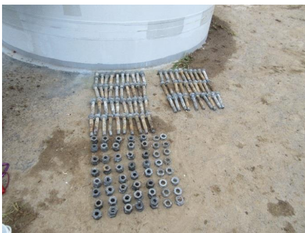
Abbildungen 18: Zerstörte Schraubengarnituren
