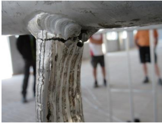
Abbildung 12: technische Mängel der Arbeitsbühne Quelle: LAGuS
