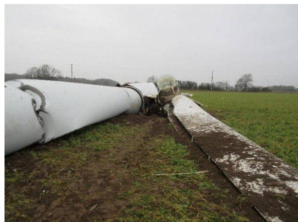
Abbildung 17: eingebeulter Turm mit zerstörten Flügeln
