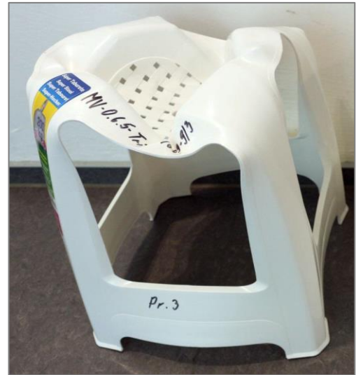
Abbildungen 15 und 16: Tonnenförmiger Tritt während und nach der senkrechten Belastung Quelle: Prüfbericht GAA Hildesheim (Abbildung 15), LAGuS (Abbildung 16)
