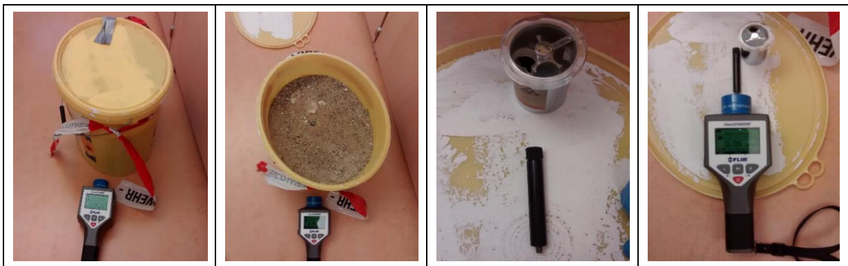
Abbildung 24, 25, 26, 27: Ortsdosisleistungsmessung an Außenseite des Sicherstellungsbehälters (Abbildung 25: in dem mit Sand gefülltem Eimer versenktes Fundobjekt), Quelle Abbildungen 24 bis 27: LAGuS
