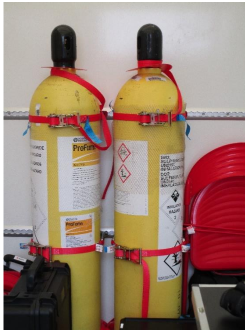
Abbildung 18: Sulfuryldifluorid in Druckgasflaschen, Quelle: LAGuS
