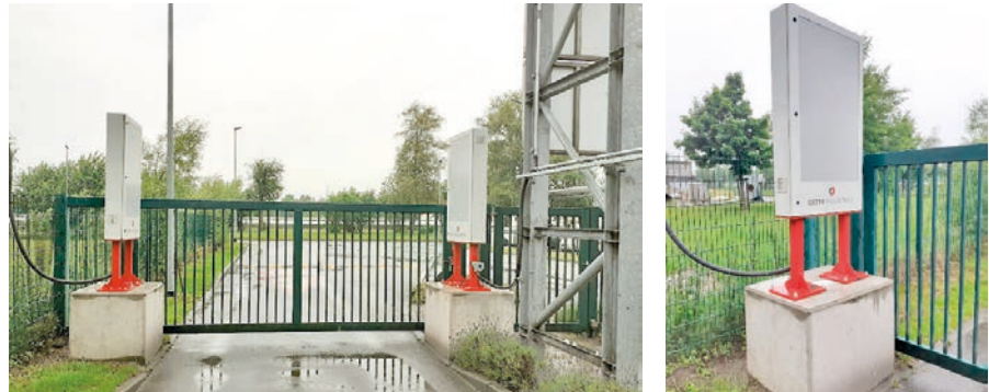
Abb. links: Portalmessanlage, Abb. rechts: Flächendetektor einer Portalmessanlage für LKW-Ladungen
